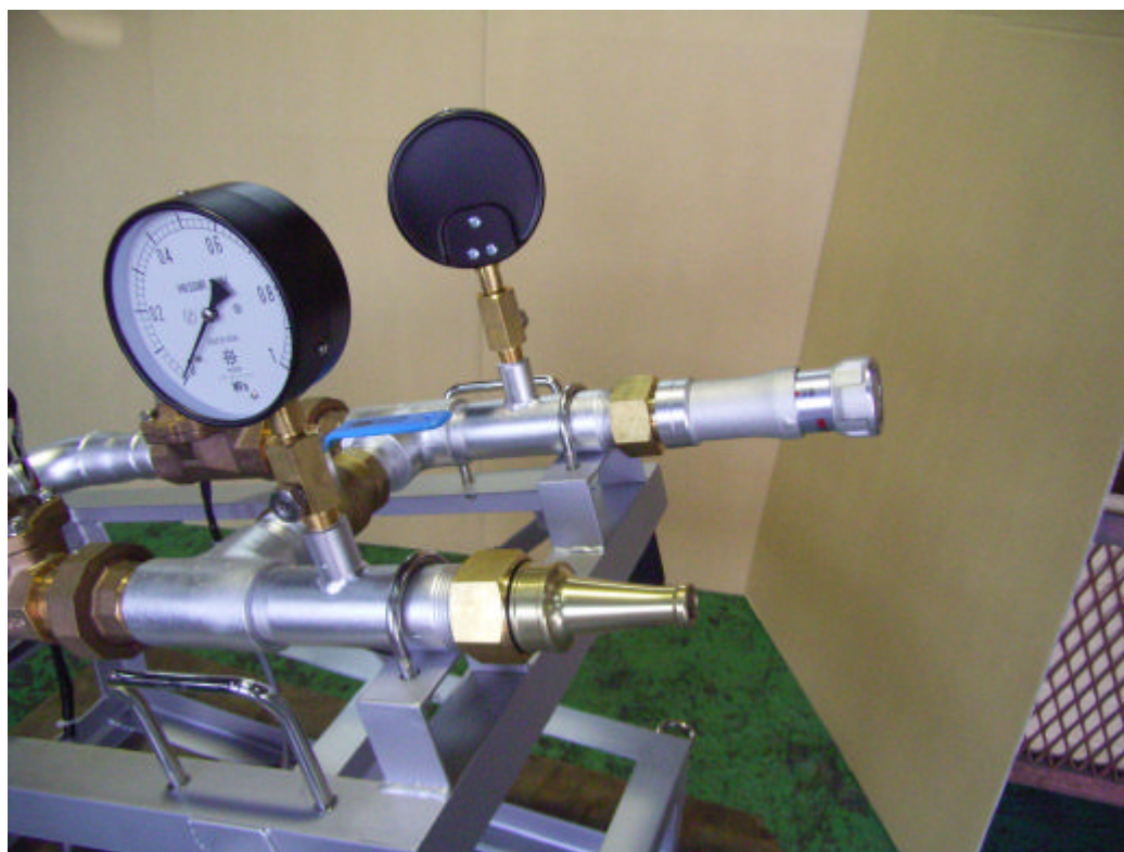
左：電磁弁制御装置、右：電磁弁式放水試験装置
